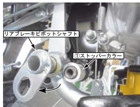
○ブレーキピボットシャフトに差し込んだ①ストッパーカラーをブレーキペダルにきっちり当たる位置にセットし②ソケットセットスクリューにネジロック剤を塗布し取り付け、規定トルクで締め付けます。
