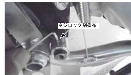
○取り外しと逆手順に引き出したリアブレーキピボットシャフトを押し込みリアブレーキピボットシャフトの穴にメインスタンドシャフトカラーを合わせ、ピボットサイドプレートを取り付け、フランジボルトを規定トルクまで締め付けます。
