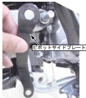
○リアブレーキピボットシャフトを若干引き出し回転させます。
