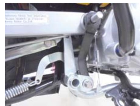
○リアブレーキのアジャストナットを緩めブレーキペダルの遊び量を調整します。
