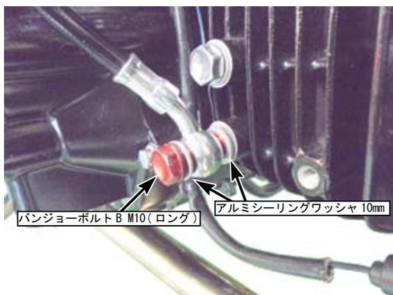
○シリンダーのオイル取出し口の上側のプラグボルトとオイルホースが干渉しない角度に調整して、各バンジョーボルトを規定トルクで締め付けます。
