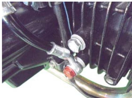
○スペシャルクラッチカバーからプラグボルトを取り外し、オイルホースをアルミシーリングワッシャ 10mm 2 枚で挟みバンジョーボルト A M10(ショート)にて仮止めをします。
