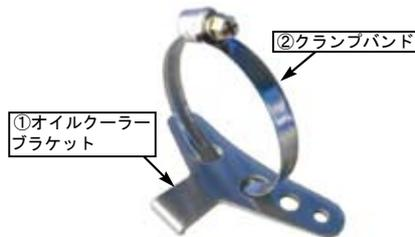
○①オイルクーラーブラケットをフレーム裏側の平らな部分に当て(ブラケット端部が曲がっている部分を下に向け、フレームの平らな場所の後端に当てるようにします。)②クランプバンドでフレームと①オイルクーラーブラケットを固定します。この時、②クランプバンドのネジ部分をタンクの下に隠れる様に、フレームの上側に固定して下さい。(この時、ワイヤーとハーネスは①オイルクーラーブラケットの下になる様に取り回して下さい。)
