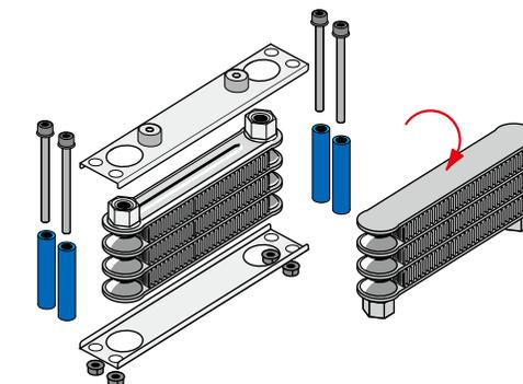
組み替え方は、オイルクーラー本体の両サイドにあるナットを外し、ソケットキャップスクリュー、カラーパイプ、オイルクーラープレートを取り外します。オイルクーラー本体を上下逆にし、オイルクーラープレートで挟み、ソケットキャップスクリューとナットで締めこみます。
