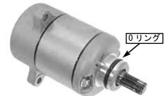
○取り外しと逆手順で①エンジン COMP. にセルモーターを取り付ける。
