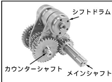
ミッションがニュートラル状態（ギアのドッグ部が噛み合っていない状態）で、クランクケースに組付ける。
