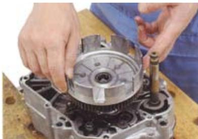
4. クラッチアウターにスプラインワッシャを取り付け 30° 回転させてロックワッシャを取り付けます。
