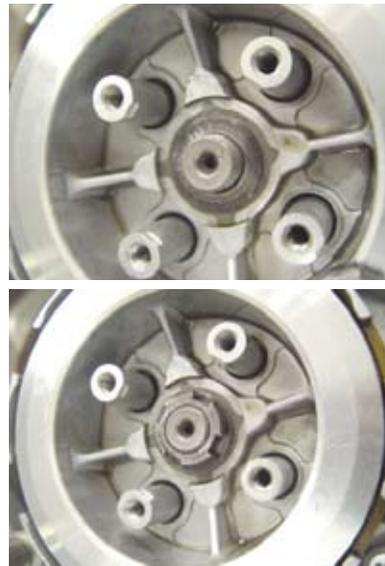
3. プレッシャープレートボス部にクラッチスプリング4本を入れ、クラッチリフタープレートをフランジボルトで取り付け、対角に2～3回に分けて規定トルクまで締め付けます。
