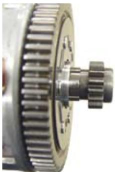
3. トランスミッションメインシャフトに、スラストワッシャ B、クラッチアウター COMP. を取り付けます。
