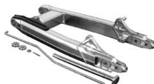
06-03-0116 アルミスイングアーム (12cm ロング) 06-03-0114 アルミスイングアーム (16cm ロング) 06-03-0115 アルミスイングアーム (16cm ロング) スタビ付
