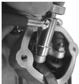
○EX側はデコンプ装置が解除されるようカムシャフトのシャフトを手前に引いた状態で調整する。
