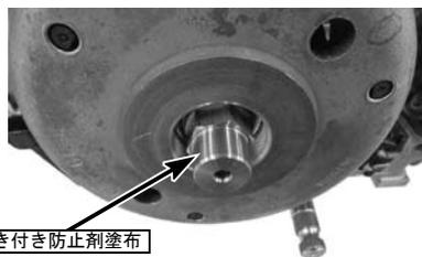
○シャフトナットにベアリングを差込みながらジェネレーターカバーをセットし、各スクリューを規定トルクまで締め付けます。
