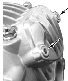
○シャフトナットにベアリングを差込みながらジェネレーターカバーをセットし取り付け、規定トルクで締め付ける。
