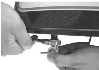
○フューエルチューブを差し込み、チューブクリップで止めます。フューエルコックを開き各部からのガソリン漏れの有無を確認します。（コックを開いたまま長時間放置しないで下さい。）
