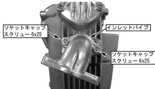
○インレットパイプに使用するキャブレターのインシュレーターをキット内のソケットキャップスクリュー2本を用いて締め付けます。
