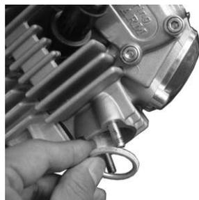
○使用するエキゾーストマフラーの取り付け指示に従いエキゾーストマフラーを取り付けます。
