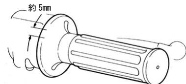
スロットルを数回スナップさせ引っかけりやスロットルバルブの全開状態を確認します。ステアリングを左右いっぱいに切った状態でもスロットルに遊びがある事を確認して下さい。
