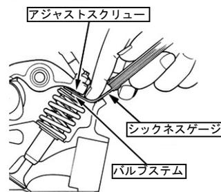
○アジャストナットを規定トルクまで締め付ける。
