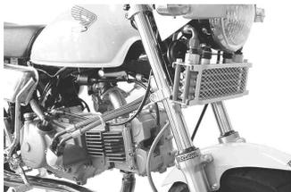
オイルクーラー本体をヘッドライト下に取り付けるキットです。取り付けは当社製ステアリングステムにステーを固定し、オイルクーラー本体をヘッドライト下に取り付けます。
