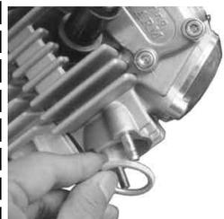
使用するエキゾーストマフラーの取り付け指示に従いエキゾーストマフラーを取り付けます。イグニッションキー、ガスコックがOFFになっていることを確認します。
