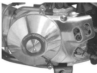
使用するチェンジペダルを取り付けます。
