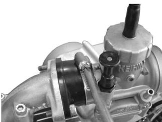
エアフィルターを取り付け、バンドを締め付けて固定する。スロットルグリップ部で5mm程度の遊びが出来るようにスロットルケーブルのアジャスターを調整します。
