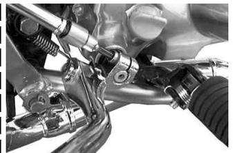
オプションのオイルキャッチタンクを取り付け、シリンダーヘッドのブリザーキャップとオイルキャッチタンクとをブリザーパイプで接続し、ホースクリップでクランプします。
