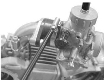
エアフィルターを取り付け、バンドを締め付けて固定する。
