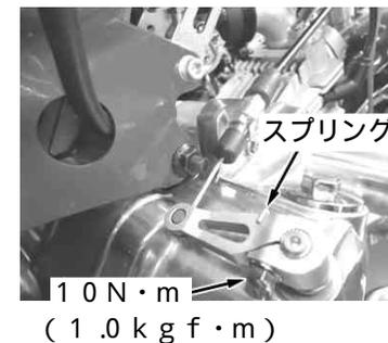
リリースアームにフランジボルトを取り付け、アームを押し込んだ状態でボルトを指定トルクで締め付ける。
