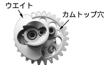
キット内のツマミネジにスナップリング6mm、プレートを通してエキゾーストカムシャフト内のスライドシャフトを引き出す。
