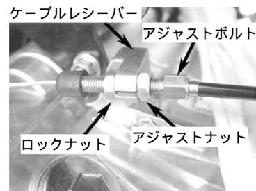
クラッチレバーのロックナット、クラッチケーブルのロックナットを締め付ける。
