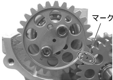
クランクを固定し、IN/EX共カムギアを固定しているソケットキャップスクリューを規定トルクで締め付ける。
