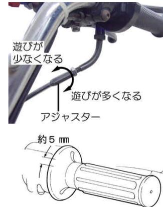
スロットルを数回スナップさせ引っかけりやスロットルバルブの全開状態を確認します。ステアリングを左右いっぱいに切った状態でもスロットルに遊びがあることを確認して下さい。
