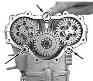
シリンダーヘッドカバーのスクリーをを外し、シリンダーヘッドカバーを取り外す。
