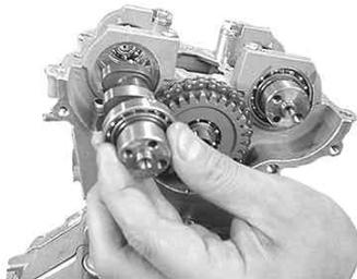
エキゾーストカムシャフト側にカムストッパー、ソケットキャップスクリュー4×16を取り付け締め付ける。
