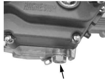
ドレンボルトを取り付け規定トルクで締め付ける。
