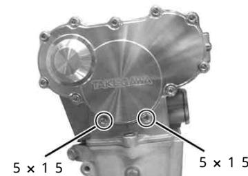
ソケットキャップスクリューをそれぞれ対角に2～3回に分け、規定トルクまで締め付ける。
