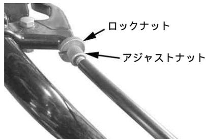
クラッチレバー部のアジャスター調整代が少なくなってきた場合は、レシーバー側のアジャストナットを回して調整する。
