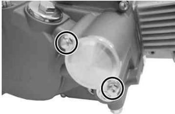
オイルフィルターカバーのOリングを点検し、必要があれば交換する。新品のオイルフィルターをフィルターカバーに取り付ける。
