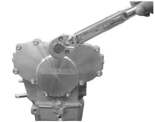
取り外したジェネレーターカバーを取り付け、規定トルクで締め付ける。
