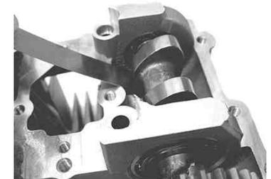
E X側はデコンプ装置が解除されるようスライドシャフトを手前に引いた状態で調整する。
