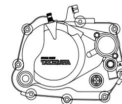
クラッチリフタープレートのフランジボルト4本を対角に2～3回に分けて取り外す。
