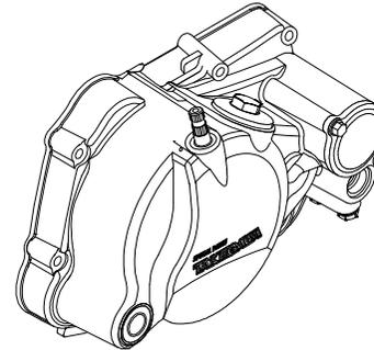
クラッチリリースアーム割り締め部の切り欠きが、後方に向くようにケーブルエンドをクラッチリリースアームにリリースアームスプリングをセットしインナーケーブルを引っ張った状態でリリースピニオンに差し込み、アームスプリングを R . クランクケースカバーに差し込みます。
