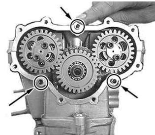
シリンダーヘッドL.サイドカバーをシリンダーヘッドにキャップスクリュー5×22 9本、5×15 2本を用いて取り付ける。(図参考) スクリューネジ部に少量のアルミスベシャルを塗布する。
