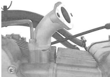
インレットパイプに使用するキャブレターのインシュレーターをキット内のソケットキャップスクリュー2本を用いて締め付けます。
