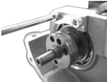
カムギアをセンターカムギアの合わせマークと合わせ、カムギアのカムトップ穴とカムシャフトのカム山のトップ部を合わせ、指定の位置に平行ピンを取り付ける。
