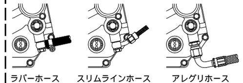
△注意：クラッチカバーにオイルホースを接続しない場合、サーモユニット又は、オイルホールプラグを絶対に取り付けないで下さい。オイル通路が遮断され、エンジンが破損する可能性があります。
