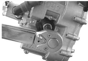
イグニッションコイルのケーブルの延長をします。コードをイグニッションコイルから約10cmの位置で切断します。キット内ハイテンションコードを、取り回しを決めた寸法で切断し、キット内のプラグコードジョイントを使用して、下図の様に接続します。
