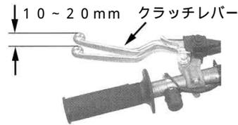
クラッチレバーのアジャストナットを回して、クラッチレバーの遊びを調整する。
