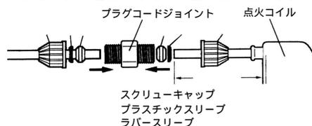
キット内のプラグキャップを延長したハイテンションコードに取り付け、プラグキャップラバーをキット付属品に交換します。
