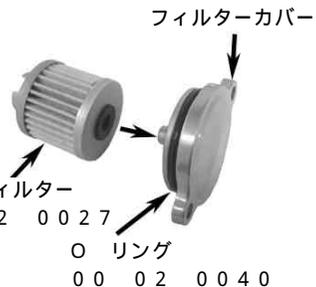
オイルフィルタースプリングを、R.クランクケースカバー内の突起部にセットする。オイルフィルターカバーのOリングに少量のエンジンオイルを塗布し、オイルフィルター、オイルフィルターカバーを取り付け、2本のボルトを規定トルクで締め付ける。
