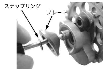
スライドシャフトの溝部にスナップリングを取り付ける。
