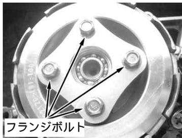
クラッチスプリングを取り外し、シムの枚数を調整する。
