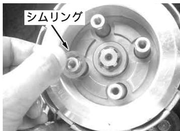
クラッチスプリングを取り付け、リフタープレートを4本のフランジボルトで取り付け、対角に2～3回に分けて規定トルクで締め付ける。
