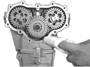
サイドカバー取り付け面ロック穴にロックピンを取り付ける。
