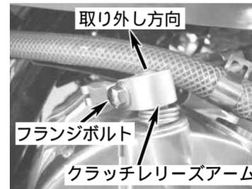
リリースアームにフランジボルトを取り付け、アームを押し込んだ状態でボルトを指定トルクで締め付けます。
