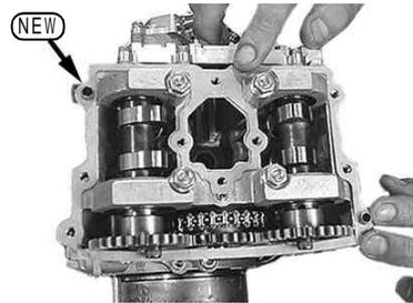
シリンダーヘッドカバーを取り付け、キャップスクリューネジ部に少量のアルミスベシャルを塗布し、内側のスクリューから対角に2～3回に分け、規定トルクまで締め付ける。
