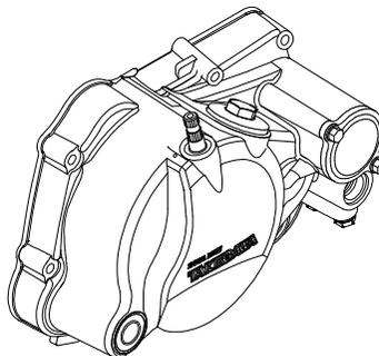
クラッチリリースアームにリリースアームスプリングをセットしインナーケーブルを引っ張った状態でリリースピニオンに差し込み、アームスプリングをR .クランクケースカバーに差し込む。
