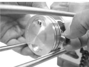
・ピストンピンサークリップ溝にピストンピンサークリップを取り付ける。
