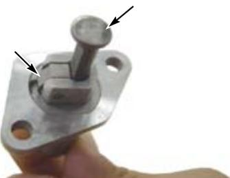
◇付属のガスケットとカムチェーンテンショナーをボルト2本でシリンダーに取り付ける。Oリング、スプリング、キャップボルトを取り付ける。
