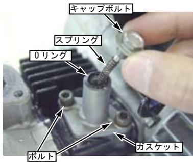
◇カムプロケットボルトを取り外してブリーザープレート/カムプロケットを取り外す。
