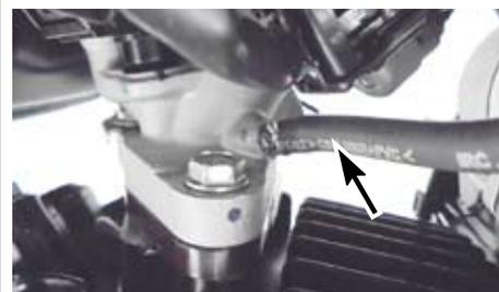
・ボスをグロメットに差し込みながらエアクリナーケースをセットする。コネクティングチューブをスロットルボディに確実に差し込み、コネクティングチューブバンドのスクリューを締め付ける。エアクリナーケースをフレームにとめている2本のボルトを仮止めした後、規定トルクにて締め付ける。吸気温度センサーのカブラを接続し、コネクティングチューブに配線をクランプする（GROMの場合）。クランクケースブリーザーホースをエアクリナーケースに接続し、フューエルブリーザーホースをクランプする。
