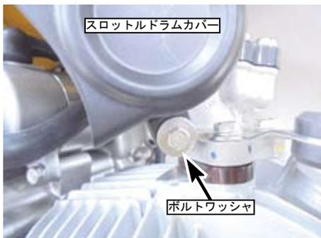
・スロットルケーブルをボルトにてフレームに取り付ける。
