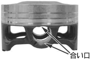
ピストンリング部及び、ピストンピン部をエアブローし、異物の噛み込みが無い事を確認します。
