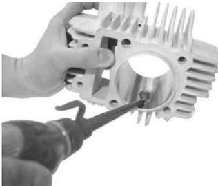
アルミシリンダーをスタートボルトに差し込み、ピストンリングの合い口がずれない様、ピストンリングを圧縮しながらシリンダーを取り付けます。
