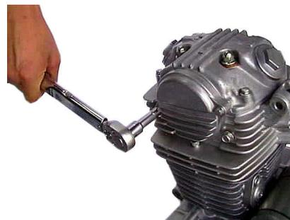
14. スターターモーターのOリングの状態を点検し、Oリングにエンジンオイルを塗布して取り付けます。スターターモーターをボルトで仮止めしておきます。このボルトは、アースケーブルと共締めとなりますのでエンジンを車体に取り付けた時に本締めして下さい。スタータリダクションギヤ、ギヤシフト摺動面にエンジンオイルを塗布し、取り付けます。Oリングの状態を点検しエンジンオイルを塗布させたスタータリダクションギアカバーを取り付け、ボルトを規定トルク10N・m(1.0kgf・m)で締め付けます。
