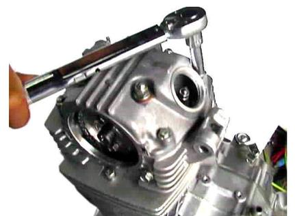
11. タイミングホールキャップ穴から見えるフライホイールのTマークを合わせマークに合わせ、圧縮上死点であることを確認して下さい。
