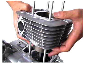
6. シリンダー合わせ面を脱脂し、チェーンガイド、ノックピン、付属のシリンダーヘッドガスケットを取り付け、シリンダーヘッドを取り付けます。
