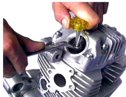
12. カムチェーンテンショナーのシーリングスクリュー、Oリングを取り外してドライバーを差し込んで時計方向に回し、テンショナーロードを引き込んだ状態で新品のガスケットを入れて、シリンダーへ取り付け、シーリングワッシャを入れたカムチェーンテンショナーソケットボルトを規定トルク12N・m(1.2kgf・m)で締め付けます。Oリングを入れたカムチェーンテンショナーリングスクリューを規定トルク4N・m(0.4kgf・m)で締め付けます。
