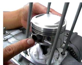
4. ピストンリングにエンジンオイルを塗布し、各リングが滑らかに回転することを確認して下さい。ピストンリングの合い口は、ピストンピン方向とその直角方向を避け、120°間隔にして下さい。（右図参照）
