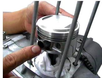
4. ピストンリングにエンジンオイルを塗布し、各リングが滑らかに回転するかを確認して下さい。ピストンリングの合い口は、ピストンピン方向とその直角方向を避け、120°間隔にして下さい。（右図参照）
