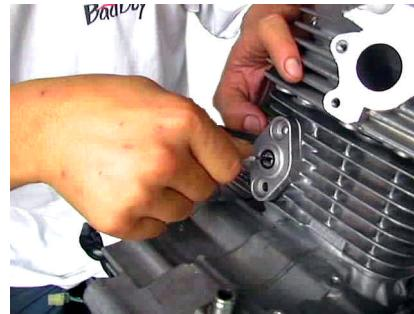
13. カムスプロケットカバーのOリングの状態を点検して、付属のカムスプロケットベースガスケットと共に取り付けます。カムスプロケットカバーをシリンダーヘッドに取り付けて、ボルトを規定トルク $1.0\text{ N}\cdot\text{m}$ ( $1.0\text{ kgf}\cdot\text{m}$ )で締め付けます。
