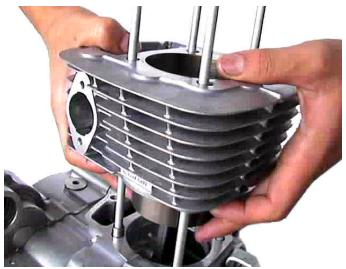
6. シリンダー合わせ面を脱脂し、チェーンガイド、ノックピン、付属のシリンダーヘッドガスケットを取り付け、シリンダーヘッドを取り付けます。
