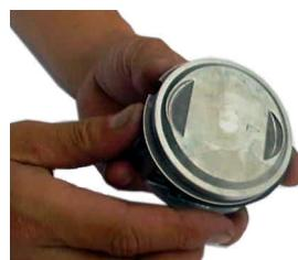
3. ピストン頭部にある“”マークをエキゾースト側に向け、付属のピストンピン、ピストンのピン穴、クランクシャフトの小端部にエンジンオイルを塗布して、ピストンピンを取り付けて下さい。
