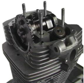
9. ノックピン、オイルホールプラグをシリンダーヘッドに取り付け、シリンダーヘッドカバー合わせ面に液体ガスケットを塗布し、シリンダーヘッドに取り付けます。
