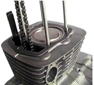
7. クランクシャフトホールキャップ、タイミングホールキャップを取り外します。クランクシャフトを反時計方向に回し、タイミングホールキャップ穴から見えるフライホイールのTマークを合わせマークに合わせて、圧縮上死点であることを確認して下さい。
