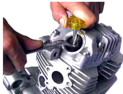
12. カムチェーンテンショナーのシーリングスクリュー、Oリングを取り外してドライバーを差し込んで時計方向に回し、テンショナーロッドを引き込んだ状態で新品のガスケットを入れて、シリンダーへ取り付け、シーリングワッシャを入れたカムチェーンテンショナソケットボルトを規定トルク $1.2\text{ N}\cdot\text{m}$ ( $1.2\text{ kgf}\cdot\text{m}$ )で締め付けます。Oリングを入れたカムチェーンテンショナーリングスクリューを規定トルク $4\text{ N}\cdot\text{m}$ ( $0.4\text{ kgf}\cdot\text{m}$ )で締め付けます。
