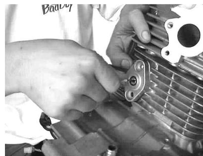
13. カムスプロケットカバーのOリングの状態を点検して、付属のカムスプロケットベースガスケットと共に取り付けます。カムスプロケットカバーをシリンダーヘッドに取り付けて、ボルトを規定トルク10N・m(1.0kgf・m)で締め付けます。
