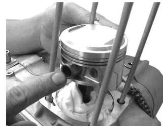
4. ピストンリングにエンジンオイルを塗布し、各リングが滑らかに回転するを確認して下さい。ピストンリングの合い口は、ピストンピン方向とその直角方向を避け、120°間隔にして下さい。（右図参照）
