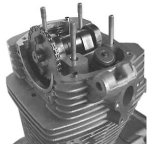
9. ノックピン、オイルホールプラグをシリンダーヘッドに取り付け、シリンダーヘッドカバー合わせ面に液体ガスケットを塗布し、シリンダーヘッドに取り付けます。
