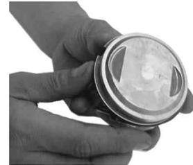
3. ピストン頭部にある“EX”マークをエキゾースト側に向け、付属のピストンピン、ピストンのピン穴、クランクシャフトの先端部にエンジンオイルを塗布して、ピストンピンを取り付けて下さい。
