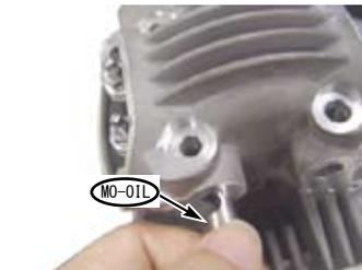
○シリンダーにキット内の 8x14 のノックピンをノックピン穴にセットします。
