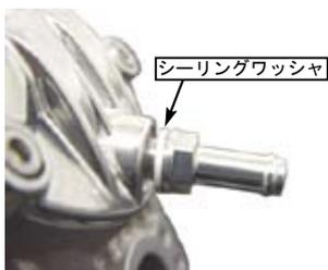
○カムチェーンテンショナー部のサイドボルトを締め付けます。
