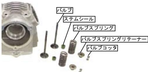
各バルブの曲がり、焼き付き、損傷を点検する。
