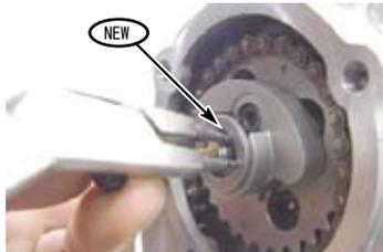
○アジャストスクリューでバルブクリアランスを調整します。
