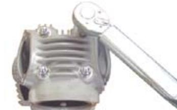
○シリンダーサイド部のサイドボルト及びシリンダーヘッドサイド部のキャップスクリューを規定トルクまで締め付けます。
