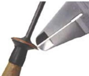
使用限度 IN:1.5mm 以上修正又は、シリンダーヘッド交換
