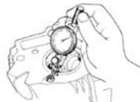
各バルブガイド内径からバルブステム外径を引いた値がガイド隙間である。
