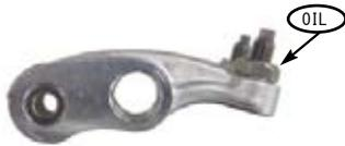
○スーパーヘッドにロッカーアームを取り付けます。キット内のロッカーアームシャフトに、モリブデン溶液を塗布し、短い方をエキゾースト側、長い方をインテーク側に取り付けます。切り欠き部分が有る方をカムチェーン側に取り付けます。
