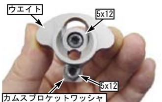
○カムチェーンをカムプロケットに取り付け、ウエイトを“0”マーク側にして、キャップスクリュー 5x12 (黒色) 2本を用いて取り付けます。
