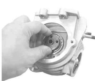
スーパーヘッドにキット内のカムストッパープレートを、トラス小ネジ2本を用いて取り付けます。この時、カムストッパーの両端とロッカーアームシャフトの切り欠き部を合わせて取り付け、規定トルクで締め付けます。
