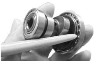
専用のカムシャフトをシリンダーヘッドに取り付けます。この時、カムシャフトの山をI N、E X 共、燃焼室側にセットします。
