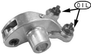
スーパーヘッドにロッカーアームを取り付けます。純正のシリンダーヘッドから取り外したロッカーアームシャフトにモリブデン溶液を塗布し、I N、E X 共に取り付けます。
