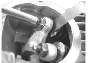
EX はデコンプ装置が働かないようカムシャフト COMP 内のシャフトを手前に引いた状態で調整して下さい。
