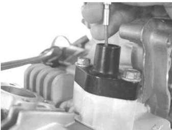
カムシャフトチェーンテンショナーのキャップボルトを取り付け規定トルクまで締め付けます。
