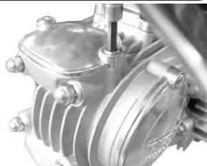
ジェネレーターカバーとクランクケースの合わせ面を脱脂し、ノックピン2個と新品のガスケットを取り付けます。ジェネレーターカバーをボルト9本で取り付け、それぞれ番号順に数回に分けて規定トルクまで締め付けます。
