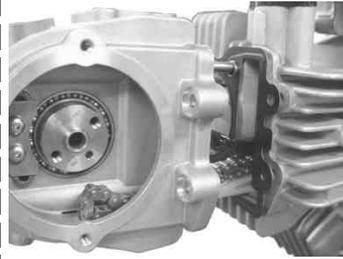
シリンダーヘッドスタットネジ部とヘッドボルトネジ部に少量のアルミスペシャルを塗布し、ヘッドナット、ヘッドボルトを取り付け仮締めします。
