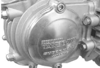
インスペクションキャップOリングに少量のエンジンオイルを塗布し、インスペクションキャップをソケットキャップスクリュー2本を用いて取り付け、規定トルクまで締め付けます。
