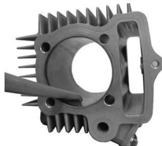
○ピストンリングを圧縮しながら、シリンダーをクランクケースに取り付けます。
