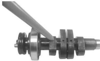
○インテークカムシャフトサポートのベアリングに、エンジンオイルを塗布し、Oリング 33mm を取り付けます。
