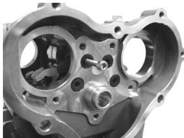
○用意したドライバーでスプリングを押しながら、突起部の下側にスプリングを掛けます。
