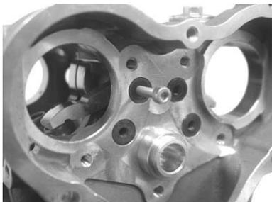
○ロッカーアームシャフトに取り付けていたネジを取り外します。
