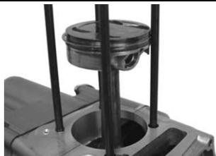
○クランクケースに詰めていたウエスを取り除き、ガスケット面を脱脂します。
