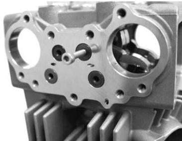
○ロッカーアームシャフトに取り付けていたネジを取り外します。
