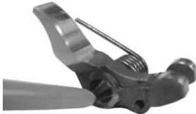
○ローワーロッカーアームにロッカーアームスプリングが付いた状態で、ロッカーアームシャフトをヘッドの所定位置に差し込み、ロッカーアームを取り付けます。
