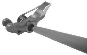
○ローワーロッカーアームにロッカーアームスプリングが付いた状態で、ロッカーアームシャフトをヘッドの所定位置に差し込み、ロッカーアームを取り付けます。
