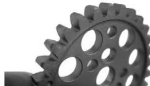
○センターカムギアのギア、スプロケットの摩耗、損傷がないか点検する。
