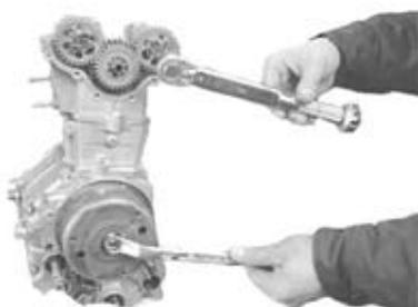
○シリンダーヘッドサイドにキット内のソケットキャップスクリュー 6x20 を取り付け、締め付けます。
