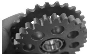
○センターカムギアのベアリングのインナーレースを指で回し、インナーがスムーズに回転するかを点検する。滑らかに回らない、インナーレースにガタがある場合、センターカムギア COMP. で交換する。
