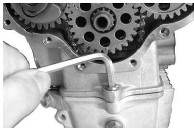
○シリンダーのカムチェーンガイドローラーボルトを規定トルクまで締め付けます。
