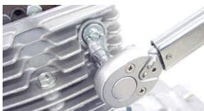
アジャスターの調整だけではガタが無くならない場合、シリンダーのアジャストボルトで調整を行います。
