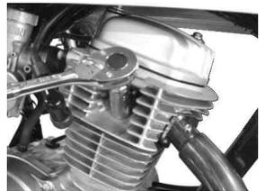
特に新品のスパークプラグを使用する場合は、耐熱潤滑剤等（アルミスペシャル）をスパークプラグネジ部に少量塗布し、締め付ける事をお願いします。
