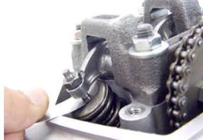
アジャストスクリューを合わせ、アジャストナットを締め付けます。
