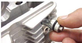
ロックボルトでセットプレートを仮止めします。
