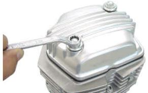
オイルチェックネジ穴に新品のシーリングワッシャ、STDオイルチェックボルトを取り付け、規定トルクで締め付けます。
