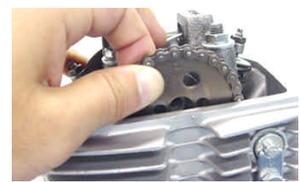
カムシャフトのボルト穴をカムスプロケットに合わせて六角ボルト2本を、仮り止めします。
