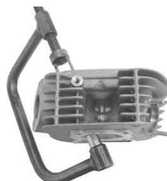
各バルブの曲がり、焼き付き、損傷を点検する。
