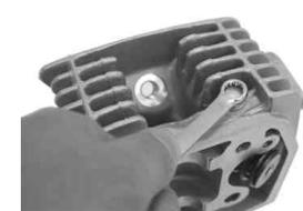
キットのカムシャフトのジャーナル面とカム面にエンジンオイルを塗布し、カムシャフトのカム山は下側に向けシリンダーヘッドに取り付けます。
