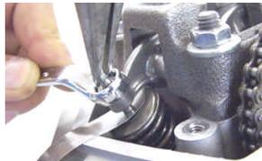
ナットを締め付け後、 $0.05\text{ mm}$ のシクネスゲージを再度差し込み、バルブ隙間を確認します。シリンダーヘッドのオイル溜りにきれいなエンジンオイルを入れます。
