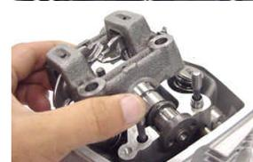
ワッシャ4個を取り付け、ナット4個の座面にアルミスペーシャルを少量塗布し、対角に数回に分けて均等に締め付けます。
