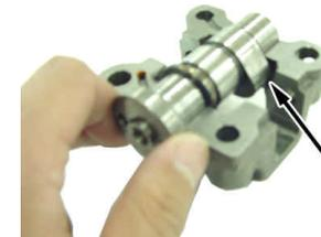
干渉が無い場合は、そのまま取り付け作業を行います。干渉がある場合は、カムシャフトホルダーの干渉部分を削り、修正します。
