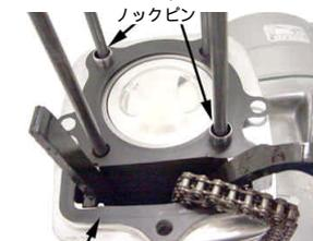
シリンダーヘッドガスケットカムチェーンをシリンダーヘッドに通し、シリンダーヘッドを取り付けます。
