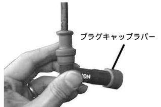
専用のスパークプラグにキット内のプラグスリーブを取り付け、スパークプラグネジ部に少量のアルミスペシャルを塗布し、スパークプラグを規定トルクで締め付けます。
