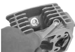
キットのカムシャフトのベアリングにエンジンオイルを塗布し、カムシャフトのカム山は下側に向けシリンダーヘッドに取り付けます。
