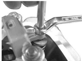
ナットを締め付け後、シクネスゲージを再度差し込み、バルブ隙間を確認します。シリンダーヘッドのオイル溜りにきれいなエンジンオイルを入れます。
