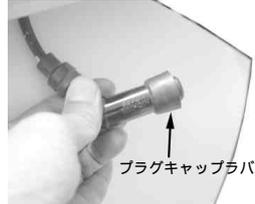
Ape100 TypeD、及びXR100R、CRF100Fは、キット内のプラグキャップをハイテンションコードに取り付け、プラグキャップラバーをキット付属品に交換します。
