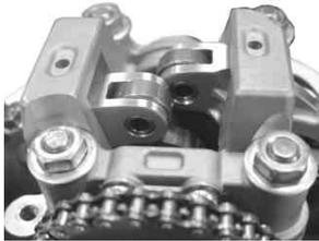
フライホイールを手で少し動かし、カムプロケットとのガタをみながら、アジャスターの“o”マークを張る方向やゆるむ方向にまわしガタが無く、フライホイールが重くならないところでロックボルトを締め込み、アジャスターを固定します。
