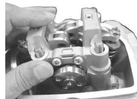
ワッシャ4個を取り付け、ナット4個の座面にアルミスペシャルを少量塗布し、対角に数回に分けて均等に締め付けます。
