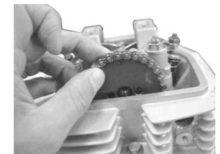
カムシャフトのボルト穴をカムスプロケットに合わせて六角ボルト2本を、仮止めします。このとき、ノックボルト(黒色ボルト)をインテーク側に取り付けます。(ベース車両がApe50/XR50モタードの場合は、クランクシャフトキットに同梱しているカムスプロケットを必ず使用して下さい。)
