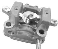
取り外したSTDロッカーアームからアジャスターボルトと、アジャスターナットをキットパーツのロッカーアームにエンジンオイルを塗布し、取り付けます。
