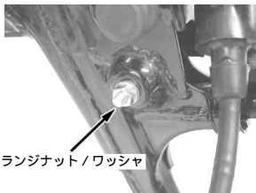
フランジボルト6×6.5/ワッシャ イグニッション コイルステー
