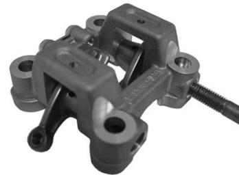
○取り外したノーマルロッカーアームからアジャストスクリューと、アジャストナットを③ロッカーアームにエンジンオイルを塗布し、取り付けます。
