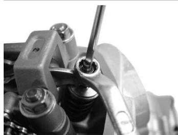
○アジャストナットを締め付け後、シックネスゲージを再度差し込み、バルブ隙間を確認します。
