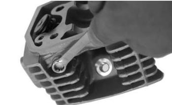
○キットの専用カムシャフトのカム面にエンジンオイル又は、モリブデン溶液を塗布し、カムシャフトのカム山は下側に向け①シリンダーヘッドに取り付けます。
