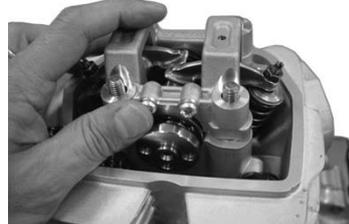
○ワッシャ4個を取り付け、ナット4個の座面にエンジンオイルを少量塗布し、対角に数回に分けて均等に締め付けます。
