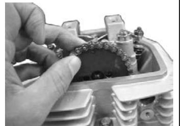
○カムシャフトのボルト穴をカムスプロケットに合わせて6角ボルト2本を、仮止めします。この時、ノックボルト（黒色ボルト）をインテーク側に取り付けます。
