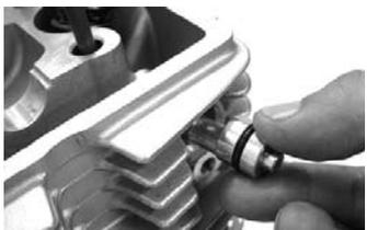
○ロックボルトでセットプレートを取り止めます。
