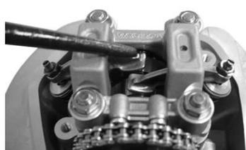
○オイルチェックネジ穴にキット内の⑦シーリングワッシャ 6.5x12、ノーマルオイルチェックボルトを取り付け、規定トルクで締め付けます。
