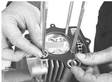
ピストンを上死点に合わせて、シリンダーヘッドを取り付けます。
