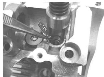
バルブステム先端を軽く2~3回たたき、バルブとバルブコッタのなじみを良くする。
