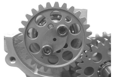
クランクを固定し、カムギヤを固定しているキャップスクリーンを規定トルクで締め付けます。
