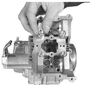
シリンダーヘッドを対角に2～3回に分けて規定トルクで取り付けます。
