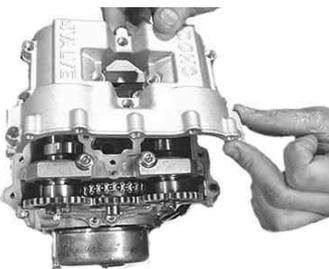
ヘッドカバーをキャップスクリュー 5 × 22 のネジ部に少量のアルミスペシャルを塗布し、10本で内側から対角に 2 ~ 3 回に分けて規定トルクで締め付けます。
