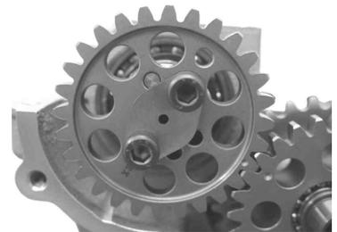
クランクを固定し、カムギヤを固定しているキャップスクリーを規定トルクで締め付けます。
