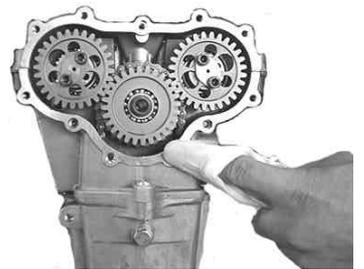
サイドカバー取り付け面ノック穴にノックピン 7 × 10 を差し込みます。
