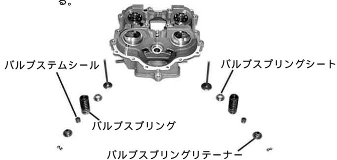
バルブを組み付ける際は、必ずエンジンオイル又はモリブデン溶液をバルブステム部に塗布する。
