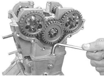
シリンダーのカムチェーンガイドローラーボルトを規定トルクまで締め付けます。
