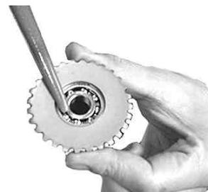
シリンダーヘッドの切り欠き部と、アイドルギヤの合わせマーク(小さいマーク)を合わせて、カムチェーンをアイドルギヤスプロケット部に取り付け、アイドルギヤをアイドルギヤシャフトを用いて取り付けます。この時、フライホイールの“T”マークをクランクケースの合わせマークに合わせた時、アイドルギヤの合わせマークが合うようにします。
