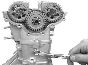
キット内のブリッジの溝にリング S - 10 を取り付け、リング部にエンジンオイルを塗布し、キット内のキャップスクリュー 4 × 12 を用いてシリンダーヘッドに取り付け締め付けます。
