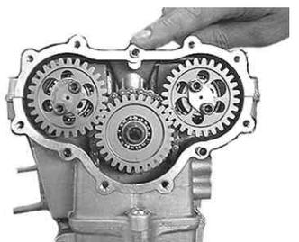
ヘッドカバーとシリンダーヘッドの合わせ面に取り付けたヘッドカバーガスケット部のインテーク側及びエキゾースト側に液体ガスケットを、薄く塗布しサイドカバーガスケットを取り付けます。
