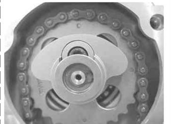
キット内の左サイドカバーOリングに少量のエンジンオイルを塗布し、左サイドカバーに取り付け、キット内のキャップスクリュー5×15 2本と5×10 1本を用いて、シリンダーヘッドに取り付け規定トルクまで締め付けます。（ネジ位置に注意）
