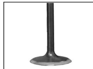
・バルブたこを使用して、バルブを軽く1回打ち、回転させる。
