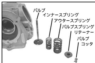
△注意：バルブ軸端に損傷があるバルブは、無理に取り外さず、バルブ軸端を修正してから取り外すこと。
