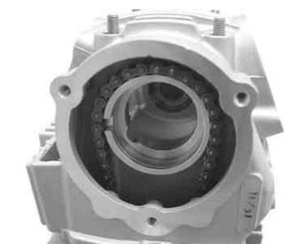
シリンダーヘッドスタットネジ部にアルミスベシャルを少量塗布し、左下部（オイルライン）にキット内の銅ワッシャ、他の部分にキット内の銅ワッシャを取り付け、キット内のフクロナット4個、キット内のキャップスクリュー6×18を図の様に取り付け、仮締めをします。
