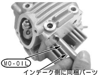
シリンダーにキット内の8×14のノックピンをノックピン穴にセットします。
