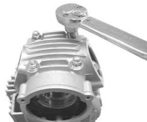
シリンダーサイド部のサイドボルト及びシリンダーヘッドサイド部のキャップスクリューを規定トルクまで締め付けます。
