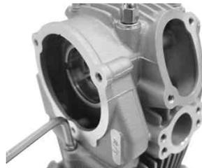
シリンダーのカムチェーンガイドローラーを規定トルクまで締め付けます。
