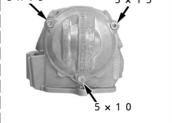
キット内のインスペクションキャップOリングに少量のエンジンオイルを塗布し、インスペクションキャップに取り付け、インスペクションキャップをキット内のキャップスクリュー5×15を用いて取り付け、規定トルクまで締め付けます。
