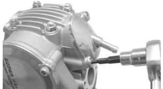
カムチェーンテンショナー部のサイドボルトを締め付けます。
