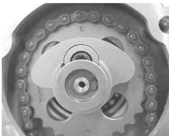
キット内の左サイドカバーリングに少量のエンジンオイルを塗布し、左サイドカバーに取り付け、キット内のキャップスクリュー5×10 3本を用いて、シリンダーヘッドに取り付け規定トルクまで締め付けます。
