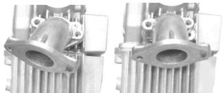
マニホールド取り付けに使用しないネジ部にソケットセットスクリューを取り付けます。
