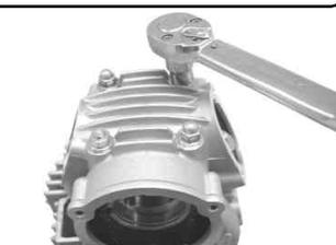
シリンダーサイド部のサイドボルト及びシリンダーヘッドサイド部のキャップスクリューを規定トルクまで締め付けます。
