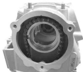
シリンダーヘッドスタットネジ部にアルミスベシャルを少量塗布し、左下部(オイルライン)にキット内の銅ワッシャ、他の部分にキット内のワッシャを取り付け、キット内のフクロナット4個、キット内のキャップスクリュー6×18を図の様に取り付け、仮締めをします。
