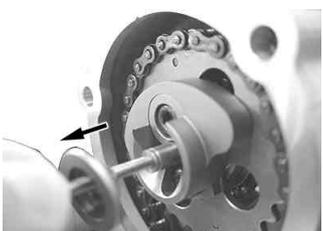
シャフトの溝部にスナップリングを取り付けます。
