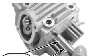
インテーク側に同梱パーツシリンダーにキット内の8×14のノックピンをノックピン穴にセットします。
