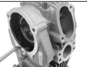
シリンダーのカムチェーンガイドローラーを規定トルクまで締め付けます。
