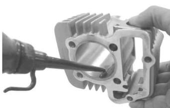
シリンダーをピストンリングの合い口の位置がずれないように指で少しずつピストンにはめていき、シリンダーをクランクケースにはめ込む。
