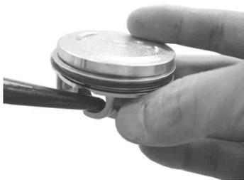
ピストン頂面の“EX”マークを下側(排気側)に向けてコンロッドに取り付ける。
