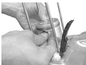
c. ピストンリングにエンジンオイルを塗布して、各リングが、滑らかに回転することを確認して下さい。ピストンリングの合い口は、ピストンリング方向とその直角方向を避け、120度間隔にして下さい（上図参照）。
