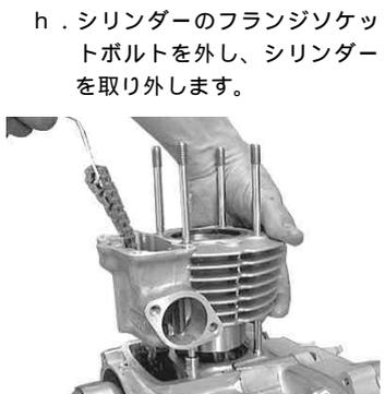
h. シリンダーのフランジソケットボルトを外し、シリンダーを取り外します。
