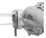
シリンダーサイド部のクランク ケースと結合するオリジナルの 6角ボルトを仮締めします。 シリンダーヘッドを取扱説明書
