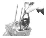
カムチェーンガイドローラーと、 シリンダーサイドボルトを仮締 めします。
