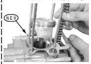
クランクケースのシリンダーベ-ス面のオイルリターン穴部にキッ ト内の新品のラバーパッキン(ブ ラック)を取り付けます。
