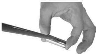
ピストンのマークがある方をエキゾーストに向け、コネクティングロッドにピストンを取り付けます。
