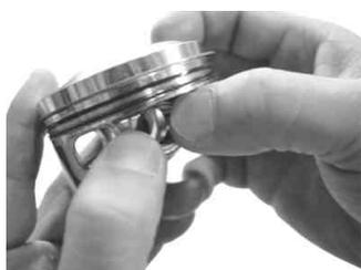
ピストンピンサークリップの合い口は、ピストンピン穴の切り欠き部を避け、ピストンに対して上下方向に合わせます。
