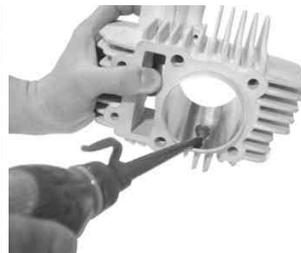
アルミシリンダーをスタットボルトに差し込み、ピストンリングの合い口がずれない様、ピストンリングを圧縮しながらシリンダーを取り付けます。
