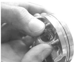
ピストンピンサークリップの合い口は、ピストンピン穴の切り欠き部を避け、ピストンに対して上下方向に合わせます。
