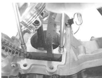
クランクケースのシリンダーベース面にキット内の部品のシリンダーガスケットを取り付けます。
