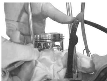
詰めていたウエスを取り外します。クランクケースのシリンダーベース面をきれいに脱脂し、ロックピン穴に、ロックピンを取り付けます。
