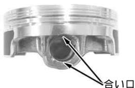
ピストンリング部及び、ピストンピン部をエアブローし、異物の噛み込みが無い事を確認します。ピストンリング溝にオイルを塗布し、図を参考にしてピストンリングを取り付け、合い口を合わせます。
