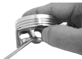
ピストンピンサークリップの合い口は切り欠き部を避け、ピストンに対し上下方向どちらかにセットします。
