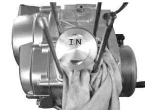
付属のピストンピンサークリップを取り付けます。ピストンピンサークリップの合い口は切り欠き部を避け、ピストンに対し上下方向どちらかにセットします。
