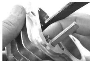
カムチェーンテンショナーのロッド先端を取り付け面と同じぐらいの位置にします。アジャストボルトで固定し、ロックナットを締め付けます。
