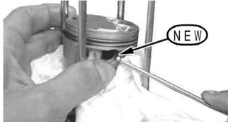
ピストンピンサークリップの合い口は、ピストンピン穴の切り欠き部を避け、ピストンに対して上下方向に合わせます。
