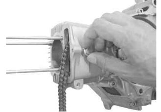
シリンダーサイド部のクランクケースと結合するソケットキャップスクリュー 6 × 2.0 を仮締めします。シリンダーヘッドを取扱説明書に従い取り付けます。シリンダーヘッド取り付け終了後、キット内のアルミシーリングワッシャ、オイルプラグボルトを取り付け、規定トルクで締め付けます。
