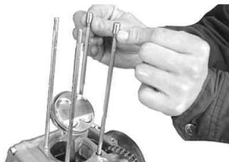
クランクケースのシリンダーベース面にキット内の部品のシリンダーガスケットを取り付けます。
