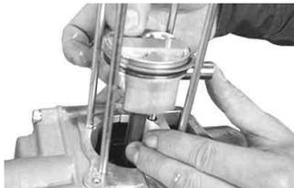
クランクケースのスリーブホール部、カムチェーンホール部にきれいなウエスを詰め込み、ピストンピンサークリップを取り付けます。
