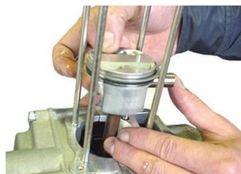
○クランクケースのスリーブホール部、カムチェーンホール部にきれいなウエスを詰め込み、ピストンピンサークリップを取り付けます。
