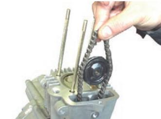
○カムチェーンガイドローラーと、シーリングワッシャ、シリンダーサイドボルトを取り付け仮締めします。
