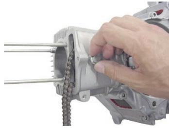
○シリンダーサイド部のクランクケースと結合するソケットキャップスクリュー6x20を仮締めします。
