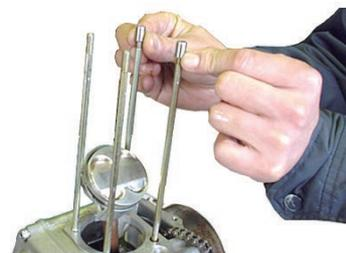
○クランクケースのシリンダーベース面にキット内のシリンダーガasketを取り付けます。
