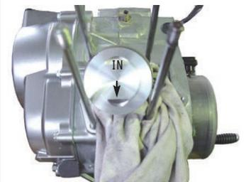
◇付属のピストンピンサークリップを取り付けます。
