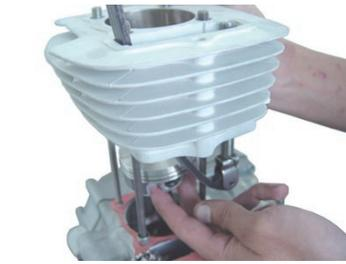
◇シリンダーにピストンリングの合い口がずれないように指で少しずつはめていきます。
