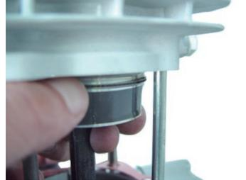
◇ピストンがシリンダーにはまったら、カムチェーンをシリンダーに通してシリンダーをクランクケースにはめ込みます。
