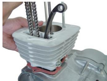
◇カムチェーンガイドの先端をクランクケースの溝に、突起部をシリンダーの溝に合わずようにして差し込みます。
