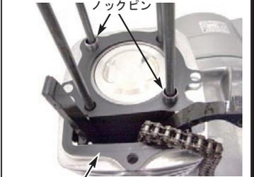
◇シリンダーヘッドキットの取り付け要領に従い、シリンダーヘッド / カムシャフトを取り付けます。
