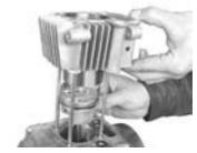
ピストンリングの合い口がずれない様、ピストンリングを圧縮しながらシリンダーを取り付けます。
