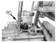
クランクケースのシリンダーベース面のオイル リターン穴部にキット内の新品のラバーパッキ ンプラックを取り付けます。
