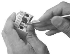
ピストンピンサークリップの合い口は、ピストンピン穴の切り欠き部を避け、ピストンに対して上下方向に合致します。
