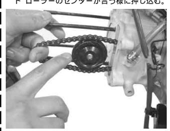
ガイドローラーボルトを取り付け、仮締めする。
