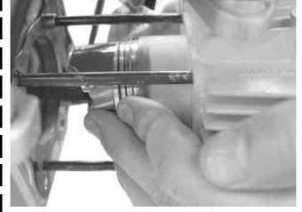
リングがシリンダーに入ったらカムチェーンをサークリップ溝に、はめ込む。ピストンピンサークリップの合い口は、ピストンピン穴の切り欠き部を避け、ピストンに対して上下方向に合わせる。
