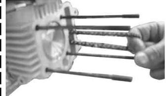
カムチェーンを引っ張りながらガイドローラーを付ける。シリンダーのガイドローラーボルト穴にガイドローラーのセンターが合う様に押し込む。
