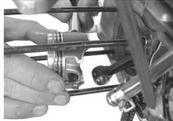
付属のピストンピンサークリップをサークリップ溝に、はめ込む。ピストンピンサークリップの合い口は、ピストンピン穴の切り欠き部を避け、ピストンに対して上下方向に合わせる。
