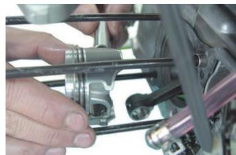
◇付属のピストンピンサークリップをサークリップ溝に、はめ込む。
