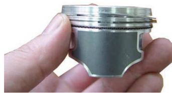
◇ピンボス部にモリブデン溶液を塗布する。
