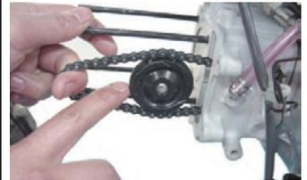
◇ガイドローラーボルトを取り付け、仮締めする。
