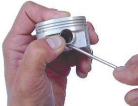
◇ピストンピンサークリップの合い口は、ピストンピン穴の切り欠き部を避け、ピストンに対して上下方向に合わせる。
