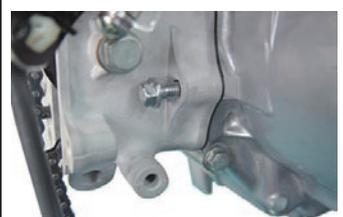
◇付属のシリンダーのボス2箇所、オイルプラグボルト / シーリングワッシャを取り付ける。
