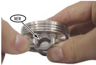
○ピストンピンサークリップの合い口は、ピストンピン穴の切り欠き部を避け、ピストンに対して上下方向に合わせます。
