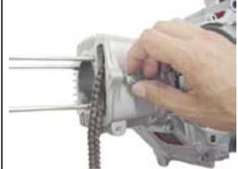
○シリンダーサイド部のクランクケースと結合するノーマルの六角ボルトを仮締めします。
