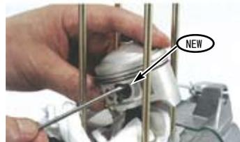
○ピストンピンサークリップの合い口は、ピストンピン穴の切り欠き部を避け、ピストンに対して上下方向に合わせます。
