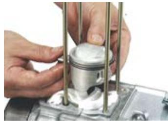
○クランクケースのスリーブホール部、カムチェーンホール部にきれいなウエスを詰め込み、ピストンピンサークリップを取り付けます。
