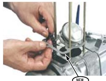
○クランクケースのシリンダーベース面のオイルリターン穴部にキット内の新品のラバーパッキンラックを取り付けます。
