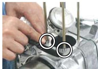
○クランクケースのシリンダーベース面にキット内の部品シリンダーガスケットを取り付けます。
