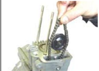
○カムチェーンガイドローラーと、シリンダーサイドボルトを仮締めします。
