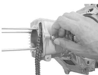
シリンダーサイド部のクランクケースと結合するオリジナルの六角ボルトを仮締めします。シリンダーヘッドを取扱説明書従い取り付けます。
