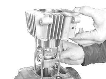
ピストンリングの合い口がずれない様、ピストンリングを圧縮しながらシリンダーを取り付けます。
