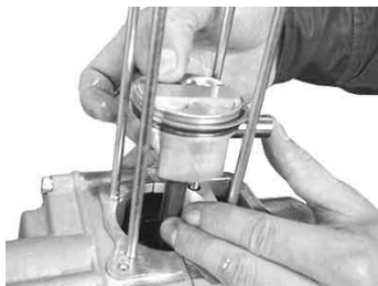
ピストン穴切り欠き サークリップの合い口
