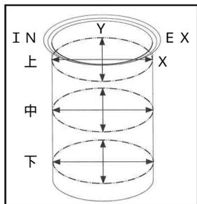
シリンダー内径が使用限度を超えている場合、シリンダーとピストンをセットで交換する。
