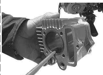
◇キットのシリンダー内にエンジンオイルを塗布し指で均等に塗り広げる。
