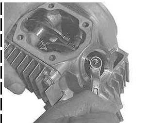
◇シリンダーヘッドに組まれているロッカーアームのタペットナットとボルトを取り外す。タペットナットを緩めた時点でタペットボルトをナットと一緒に取り外す。
