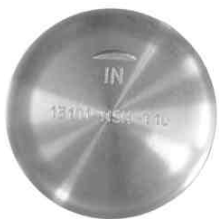
◇“IN”文字が上（インテーク側）になるようにピストンを取り付ける。
