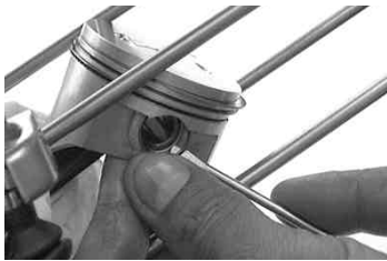
◇ドライバーでピストンにキズを付けないように押し込むと比較的簡単に取り付けられます。押し込み中にサークリップが外れて飛んでしまうことがあるので慎重に行ってください。目に入らぬように防護めがねなどを着用して下さい。
